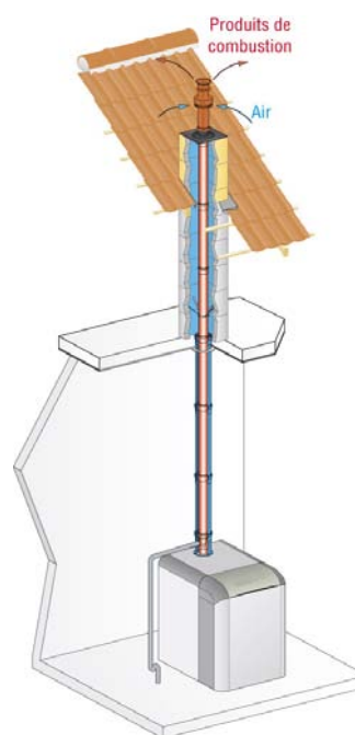
Figure 3b- Réutilisation d'un conduit existant départ plafond
