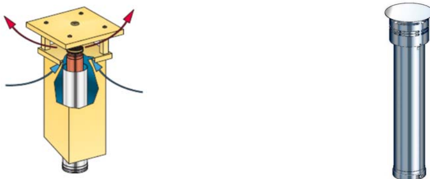
Figure 6 – Les terminaux du système 3CE P MULTI+ à l'intérieur d'un bâtiment
