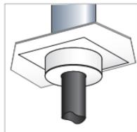
Le conduit doit déboucher dans l'intégralité de sa section extérieure dans le local où sera situé l'appareil ou la cheminée. La liaison ne doit pas se situer dans l'épaisseur du plafond ou dans le volume d'un faux plafond.
